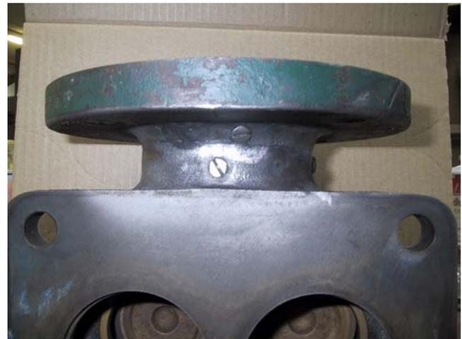
In ein älteres gerissenes Ventil mit einem gebrochenen Flansch wurde zunächst ein Stück Rohr mit geeignetem Durchmesser eingesetzt und durch das PolymerMetal MM-metall SS-Stahl mit dem Ventil verbunden. Anschließend wurde diese Verbindung durch eine Verschraubung gesichert.
