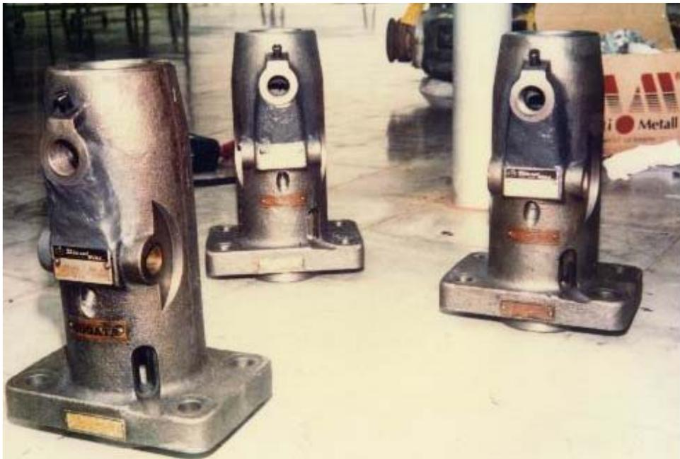
Reparatur von gerissenen Dieselinjektionspumpen mit MM-metall SS-StahlKeramik und Härter gelb.
